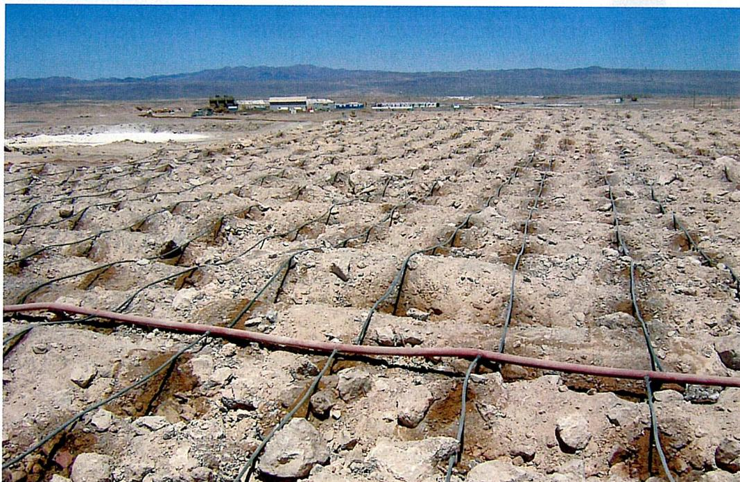
**Este tipo de gotero ofrece mayor durabilidad en la operación, ya que una vez dado de baja en la lixiviación primaria, es reciclado en las operaciones de lixiviación secundaria y OBL.**
